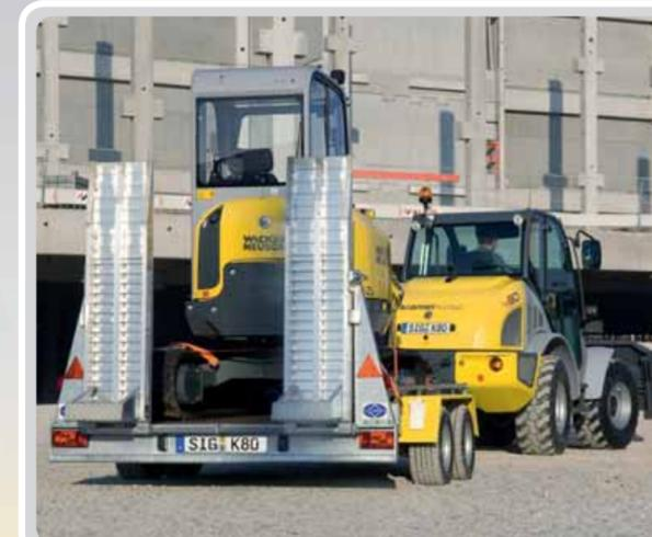
Die Verbindung des intelligenten Fahrtriebs mit der Anhängerkupplung an der Kramer Maschine setzt ein zusätzliches Plus in Bewegung: Den Einsatz als vollwertige und dynamische Zugmaschine.
